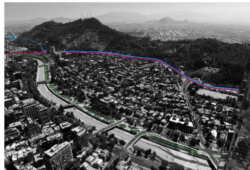
Vista aérea del Barrio Pedro de Valdivia Norte con los tres trazados propuestos para el tramo central de Costanera Norte. Tramos con línea continua en trinchera abierta y con línea segmentada en túnel.
